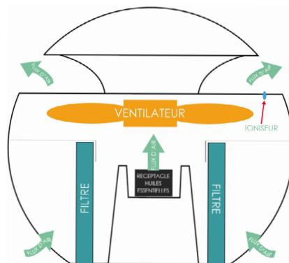
Le ventilateur aspire l'air par les ouvertures situées sous l'appareil. L'air est purifié grâce à un filtre à particules de type E11 qui retient pollens, bactéries et petites particules.
