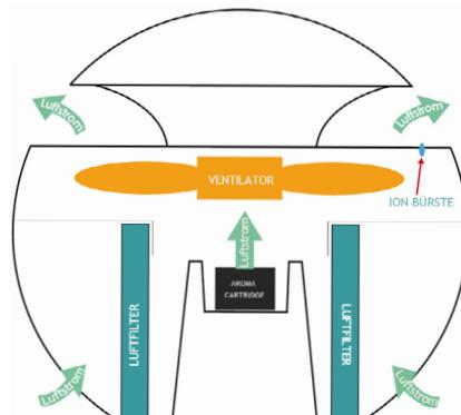
Der Ventilator saugt die Luft durch die unteren Öffnungen des Gerätes ein. Die Luft wird dank eines Partikelfilters des Typs E-11 von Pollen, Bakterien und anderen kleinen Partikeln bereinigt und gefiltert.
