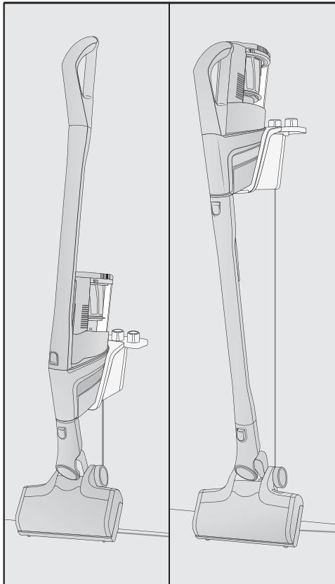
Für die Wandmontage benötigen Sie einen geeigneten Standort in der Nähe einer freien Netzsteckdose.
