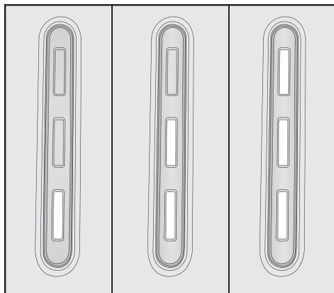
Wenn der Akku voll geladen ist, schaltet sich die Anzeige Akku-Ladezustand aus, um Energie zu sparen.
