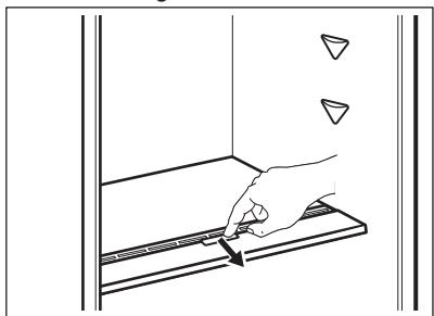
Om de vochtigheidsregelaar te verwijderen, open u de lade onder het glazen schap en trekt u het deksel eruit.
