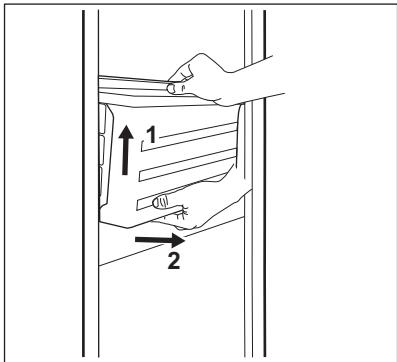
4. Duw de rails in de kast om schade aan het apparaat te voorkomen bij het sluiten van de deur.
