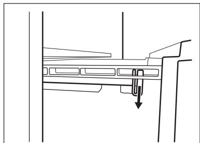
3. Ziehen Sie die Schublade heraus, während Sie sie nach oben heben, und lösen Sie sie von den Schienen.
