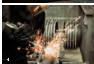
1 Fusión | 2 Molde | 3 Vertido en un molde único de arena, que se destruye tras su uso | 4 Rebabado para eliminar las imperfecciones
