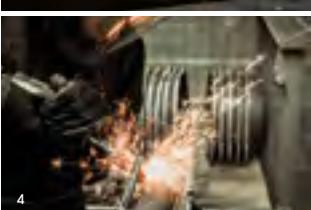
**1** Schmelzen | **2** Form | **3** Gießen in eine individuelle Sandform, die nach Gebrauch zerstört wird | **4** Entgraten zur Entfernung von Unregelmäßigkeiten
