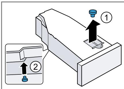
2. Nettoyer le filtre du réservoir d'eau de condensation.
