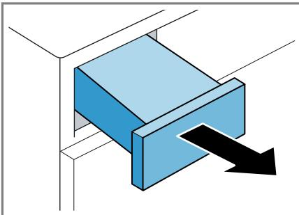
2. Vider le réservoir d'eau de condensation.
