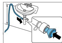
Fixez le point de raccordement avec un collier de serrage (12-22 mm). Fixez le tuyau d'évacuation d'eau avec un guide de flexible à une hauteur minimale de 80 cm et maximale de 100 cm.
