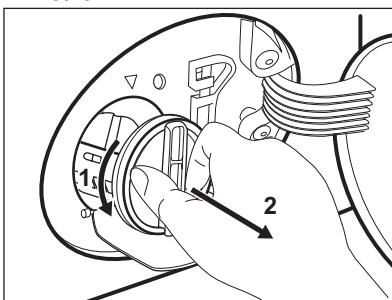
8. Si nécessaire, retirez les peluches et objets du logement du filtre.
