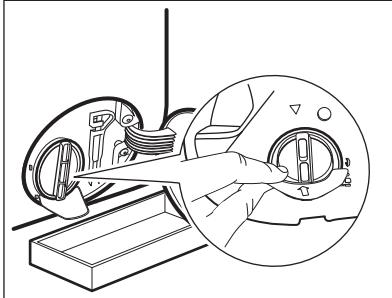
4. Tournez le filtre à 180 degrés vers la gauche pour l'ouvrir, sans le retirer. Laissez l'eau s'écouler.
