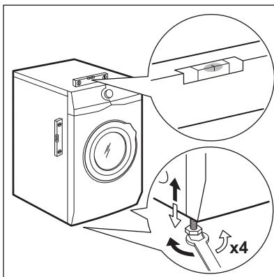
L'appareil doit être stable et d'aplomb.
