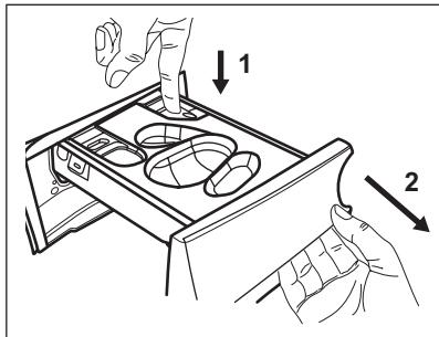
2. Retirez le compartiment réservé à la lessive liquide, s'il est inséré.
