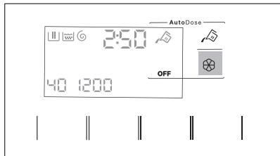
5. Pour régler le dosage de base, appuyez sur les touches correspondant aux réservoirs jusqu'à ce que le dosage de produit de lavage et deux flèches s'affichent en bas de l'écran. Appuyez sur la Température touche à plusieurs reprises pour diminuer le dosage et sur la Essorage touche pour l'augmenter : l'incrément minimum est de 1 ml (à chaque étape) ou 10 ml (lorsque la touche est maintenue enfoncée).
