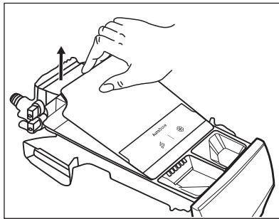
4. Pour éliminer tout résidu de détergent ou si vous placez un mauvais additif dans les réservoirs, videz le tiroir dans un bac ou dans des récipients appropriés pour recueillir le liquide.
