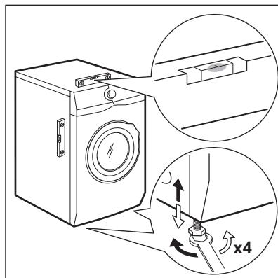
L'appareil doit être stable et d'aplomb.
