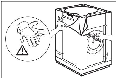
2. Retirez le dessus en carton et les matériaux d'emballage en polystyrène.
