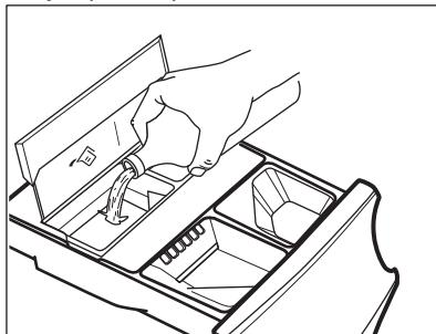
4. Versez doucement l'assouplissant uniquement, dans le réservoir AutoDose pour l'assouplissant . Remplissez-le jusqu'au repère maximal **MAX**.
