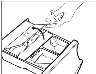
3. Versez doucement de la lessive liquide uniquement, dans le AutoDose réservoir pour la lessive . Remplissez-le jusqu'au repère maximal **MAX**.
