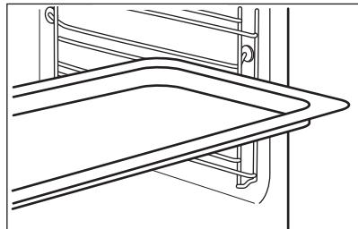
Poussez la plaque entre les rails du support de grille. Placez la plaque de cuisson avec la pente vers l'arrière de l'intérieur du four.
