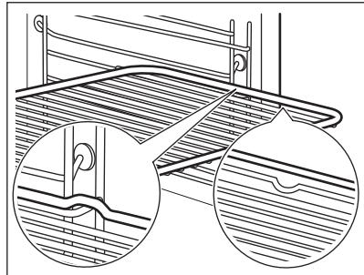
Insérez la grille entre les barres de guidage des supports de grille. Assurez-vous que la grille touche l'arrière de l'intérieur du four.
