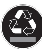
Cet autocollant ou un autocollant similaire peut se trouver au dos de l'appareil. Il indique que des panneaux d'isolation sous vide (VIP) ou des panneaux de perlite se trouvent dans la porte et/ou dans le boîtier. Cet avertissement ne concerne que le recyclage. Ne pas enlever l'autocollant.
