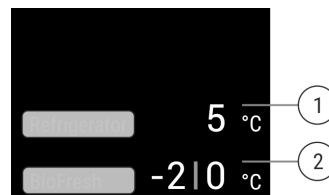
Fig. 8 L'affichage d'état indique la température réelle.\*
