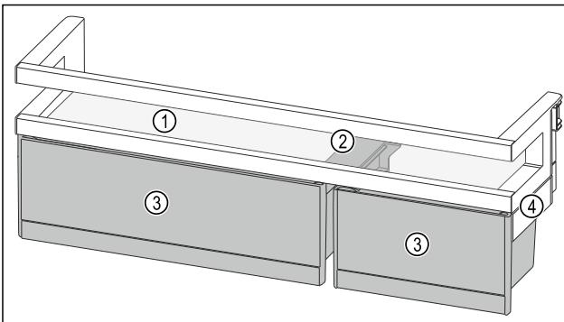
Fig. 88 Représentation à titre d'exemple d'un balconnet de contre-porte avec VarioBoxs
