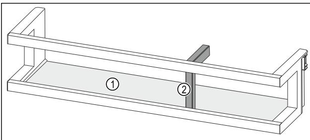
Fig. 89 Représentation à titre d'exemple d'un balconnet de contre-porte avec porte-bouteilles
