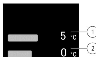
Fig. 9 L'affichage d'état indique la température réelle.\*
